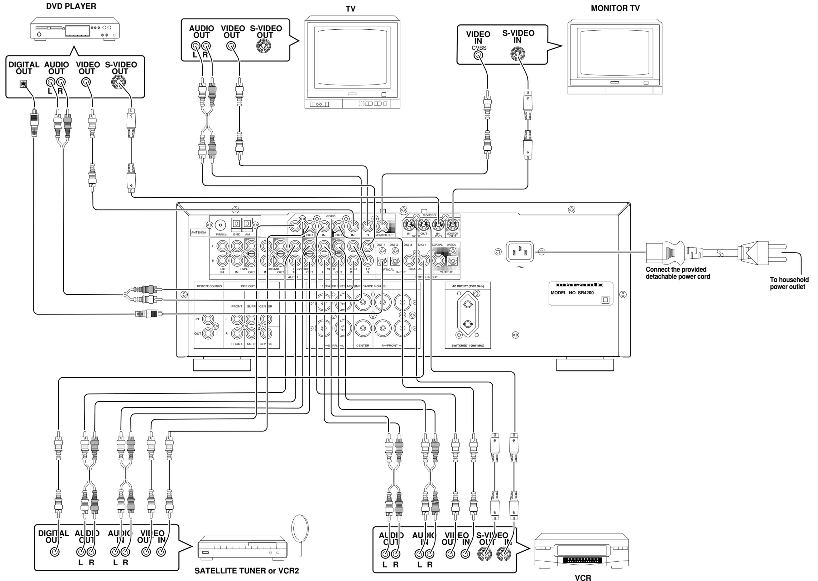
**AUDIO SYSTEM CONNECTIONS FOR AUDIO COMPONENTS**
